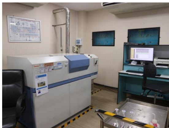
รูปที่ 2.1-20 เครื่องตรวจตะกั่วและ TDS ระบบอัตโนมัติ
